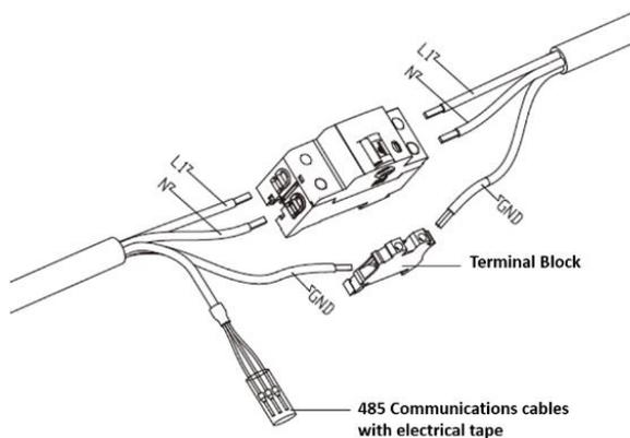
**Figura 3-13 Cablaggio della scatola di distribuzione per monofase**
