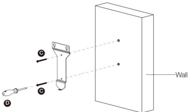
**Figura 3-3 Fissaggio del supporto a muro**
