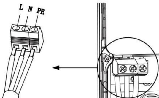
**Figura 3-11 Cablaggio monofase**
