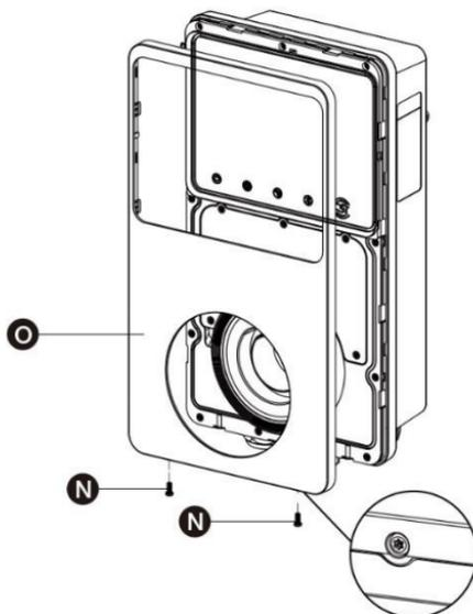
**Figura 3-9 Rimozione del pannello di manutenzione**
